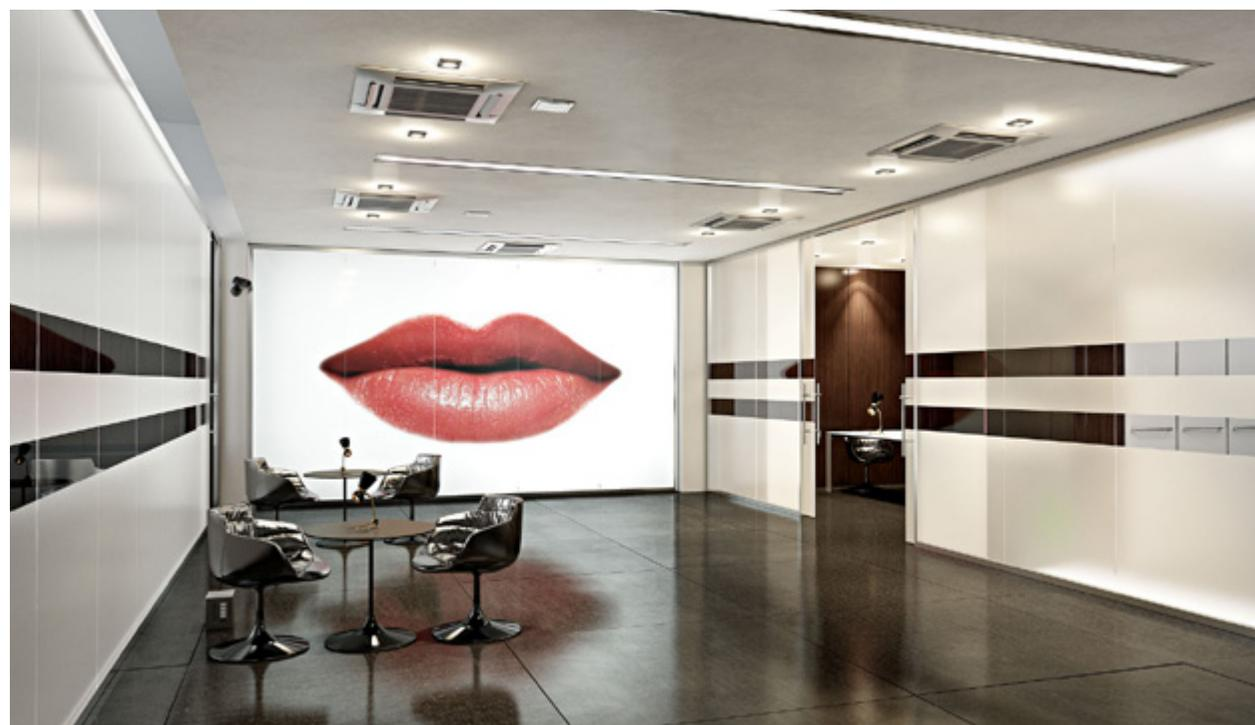
Kristal 5 è una parete monolitica con spessore 5 cm. Dispone di regolatori in ottone/alluminio a terra e profilo perimetrale quadro. Nella Kristal 5 è possibile scegliere fra tre tipologie di angoli: angolo da 45°, da 90° e l'angolo a tre vie.
