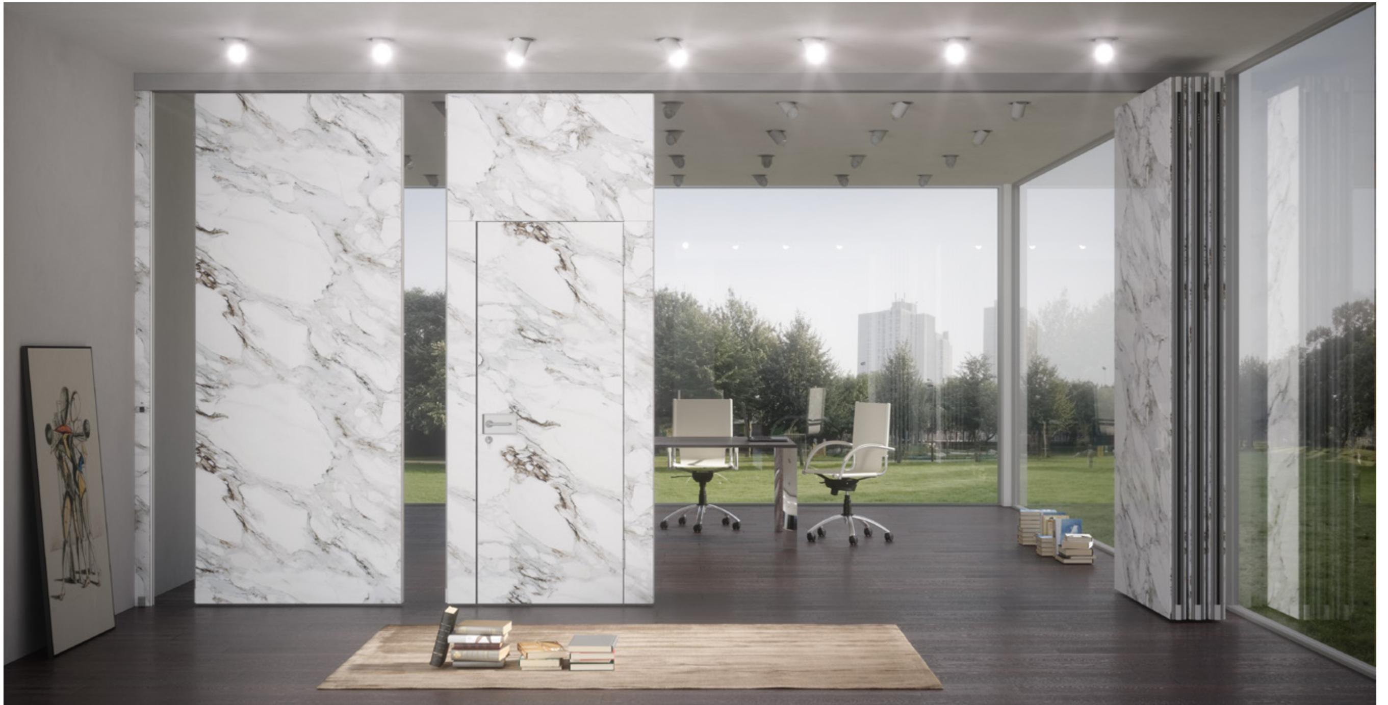
I moduli divisori della parete manovrabile Rolling Wall CE sono realizzati a misura, ogni progetto viene seguito e calcolato per la migliore realizzazione estetica ed acustica. La parete è certificata per l'isolamento acustico da 38,7 dB standard a 43dB con kit.
