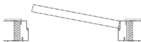
Cerniera a scomparsa (verificare fattibilità con ufficio tecnic) Hidden hinges
