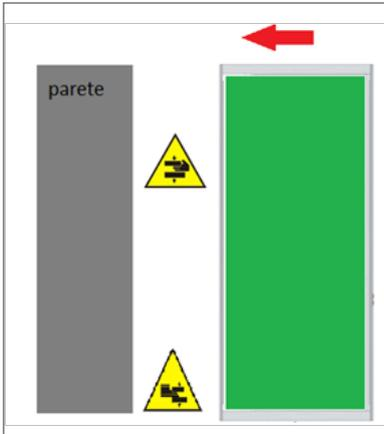
Durante il posizionamento dei moduli esiste il pericolo di schiacciamento degli arti. Il posizionamento deve essere effettuato avendo l'accortezza di avvicinare i moduli con cautela evitando che gli arti siano interposti tra modulo e modulo o modulo e parete.
