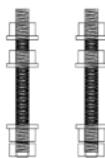
Button h 50 mm e \varnothing 6 mm per il fissaggio del binario a vista su solaio in ferro 28.190
