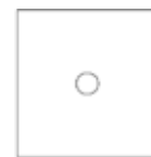
10. Piastra in acciaio 50 mm x 58 mm x 5 mm per aggancio binario con incasso 26.317
