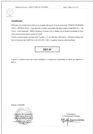
Resistenza al Fuoco / Fire resistance: REI 45 (Parete Divisoria / Partition)
